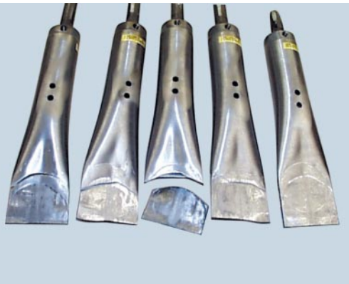
Bild 3 | Dauerfestigkeitsversuch an lasergeschweißten Außenrohren ( \pm 181 Nm, 300.000 Lastwechsel, Ergebnis: gasdicht, keine Risse in der Naht, Rohr abgerissen)
