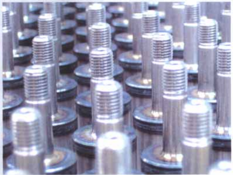
! Bild oben: Materialfluss von links (Rohr und Boden ungeschweißt) zur Mitte (Schweißstation) nach rechts (Fertigmaterial), Bild unten: Lasergeschweißte Kolbenstangen für Mercedes A- und B-Klasse
