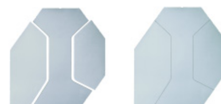
Einzelteile eines Engineered Blanks vor und nach dem Schweißen.
